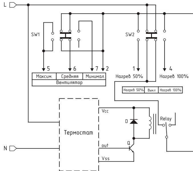
Рис. 5. Электрическая схема подключения завес без БКУ (П4050W\*, П4060W) (для максимальной скорости)
