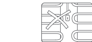
Не устанавливайте датчик температуры пола между витками нагревательного кабеля
