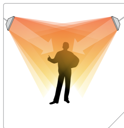
Возможна установка под углом, позволяющая повысить эффективность обогрева
