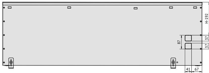
Вид сбоку конвектора Ntherm Maxi 180 с U-образным бортом.
