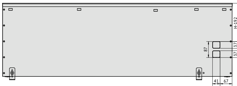
Вид сбоку конвектора Ntherm Maxi 300 с U-образным бортом.
