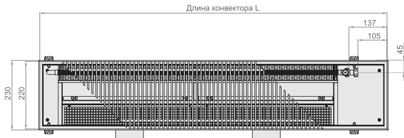
Вид сверху конвектора Ntherm Air 230.150 с роликовой решеткой, с U-образным бортом.
