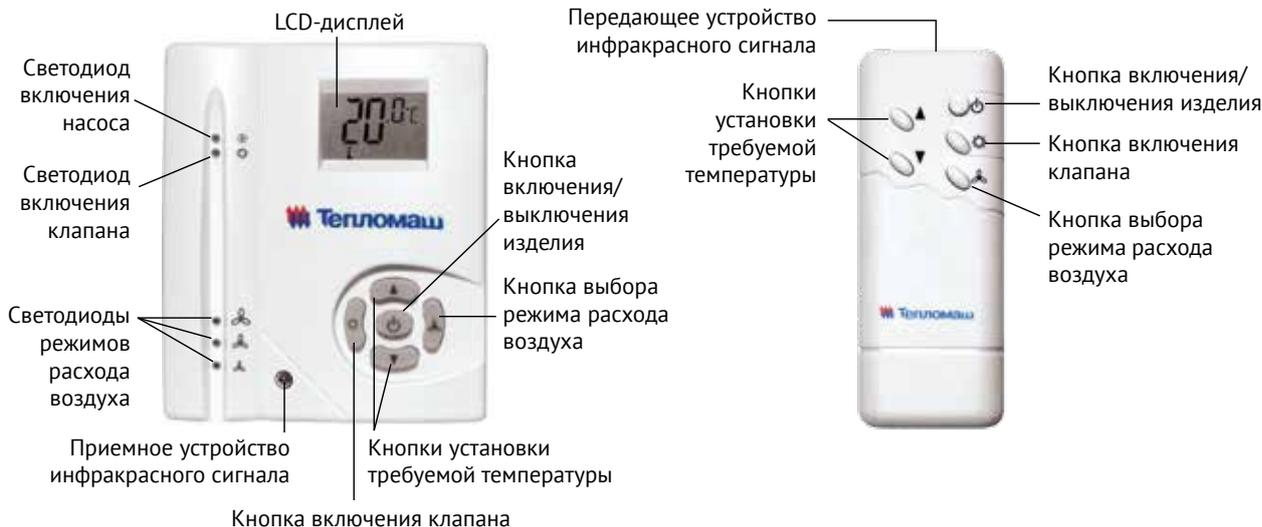
Завесы и тепловентиляторы с водяным источником тепла комплектуются выносным пультом управления (комплект проводной пульт с термостатом и беспроводной ИК пульт), позволяющим:
