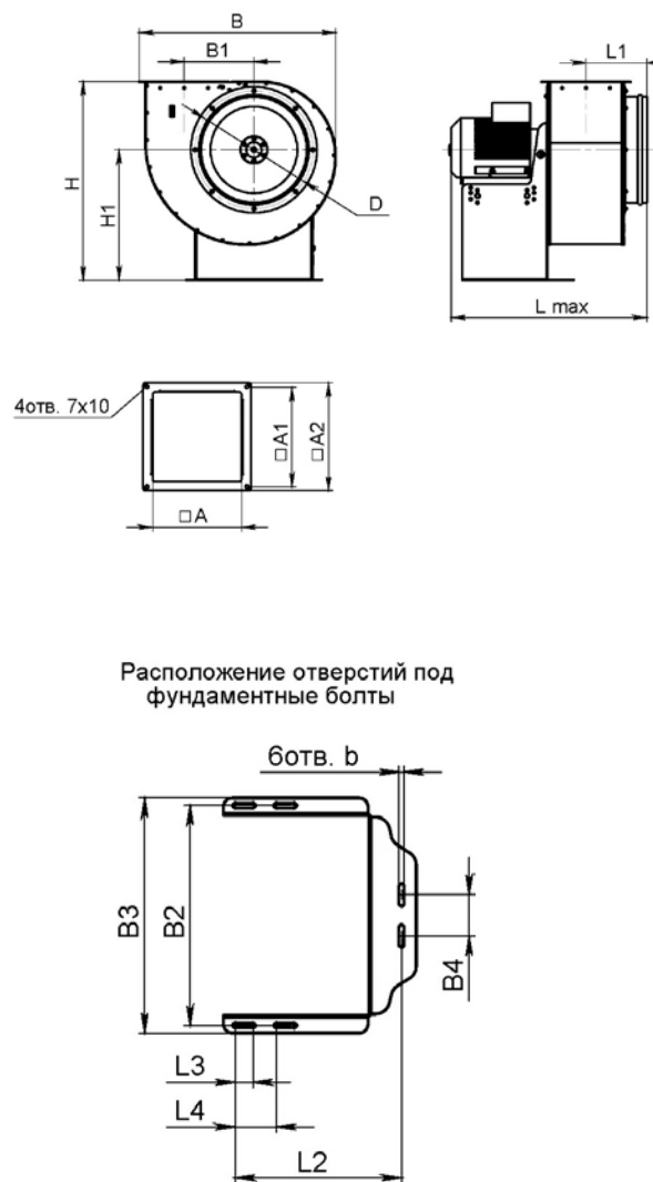
Рис.1. Общий вид и размеры вентилятора
