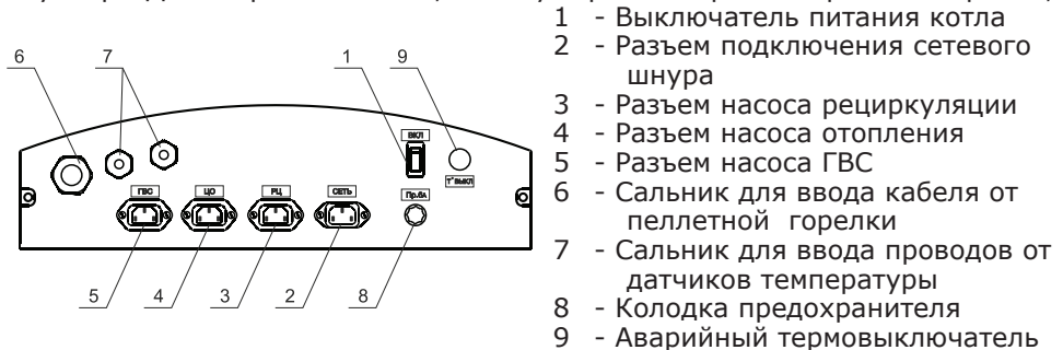
Рис.6 Расположение органов управления на задней панели пульта
