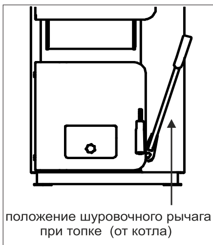
Рис. 10 Установка рычага шуровочного механизма
