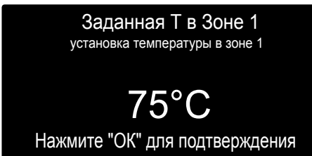
Изменение температуры горячей воды отопления
