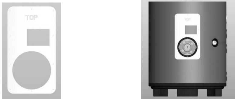
Рис.3 Установка монтажного шаблона на корпусе водонагревателя
