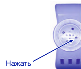
Рис.3. Расположение штока на термовыключателе термостата
