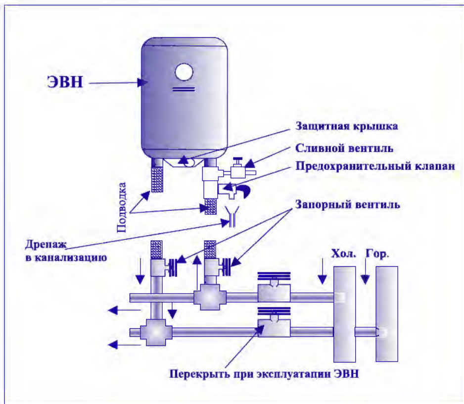
Рис. 1. Схема подключения ЭВН к водопроводу
