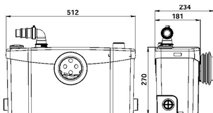
Благодаря большому объему корпуса и особому мотору **SANIPLUS®** «Бесшумный» способен откачать значительное количество сточных вод из ванной комнаты. Насос рассчитан на продолжительную работу.
