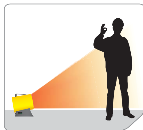
Корпус пушки расположен под углом, поэтому при стандартной установке на уровне пола техника эффективнее обогревает предметы и людей
