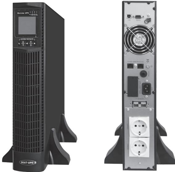
**220 В, 1000 ВА (900 Вт) On-Line, синусоидальная форма выходного напряжения, световая и звуковая индикация режимов работы, ЖК дисплей. Встроенные АКБ 9 Ач, 2 шт, время резерва 3 мин. Возможность подключения внешних АКБ. Дистанционный мониторинг по RS 232, USB, порт для платы релейного интерфейса. Возможность подключения SNMP-модуля DL 801. Функция удаленного аварийного отключения выходного напряжения (EPO). Корпус под 19» шкаф, высота 2U или настольная установка.**
