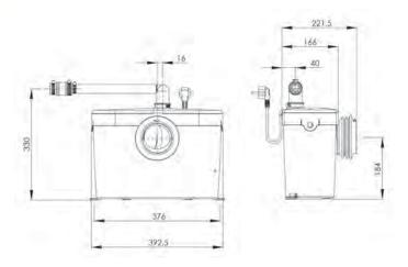
Новый насос **SANIACCESS®** 1 для подключения унитаза. Легкий доступ для обслуживания и ремонта насоса.
